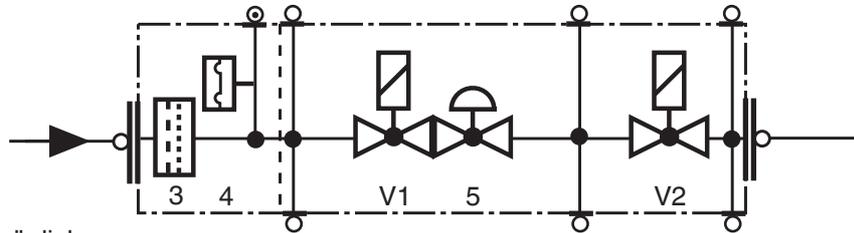
Anbau des Ventilprüfsystem VPS 504 möglich
