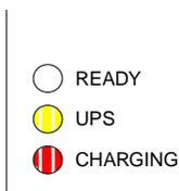
5. Überprüfen des Zustands der Batterien: Sind diese total entladen (Kapazität < 10%) werden sie zuerst geladen. Nur die *“Laden“ LED* leuchtet in dieser Zeit rot. Erst wenn die minimal erforderliche Kapazität erreicht ist, wird die Pufferbereitschaft zugeschaltet
