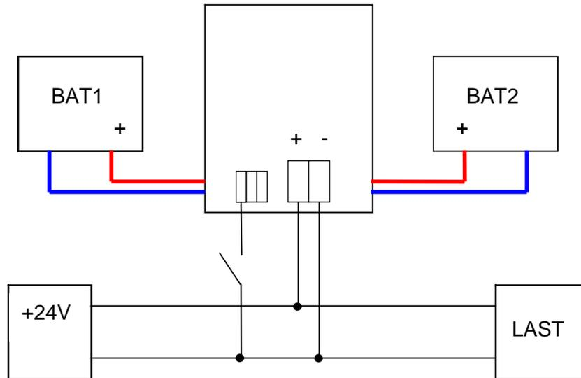
**Bitte die Verbindungskabel Steuereinheit zu den Batterien auf Grund des Spannungsabfalls so kurz wie möglich halten**
