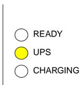
4. Überprüfung der AUS Klemme. Ist diese nicht mit Masse (–) verbunden, blinken die rote und gelbe LED. Die Pufferbereitschaft wird nicht zugeschaltet.
