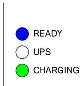
8. Eine Minute nach dem Start der Anlage und alle 24 Stunden werden die beiden Batterien einer Zustandsprüfung unterzogen. Sollte eine der beiden Batterien vom System als Defekt erkannt werden, wird der Anwender durch eine blinkende rote *“Laden“ LED* dazu aufgefordert die Batterien zu wechseln.
