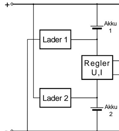
Zum Einsatz werden sie an den Gleichspannungsausgang eines 24V-DC-Netzteils angeschlossen (siehe Blockschaltbild) und die Klemme „AUS“ mit Minus verbunden.
