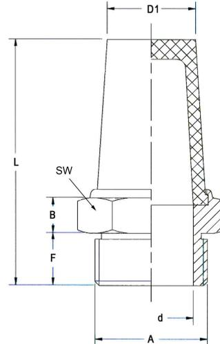
**Schalldämpfer** aus Sinterbronze, mit Messing-Sechskant und Messing-Gewinde
