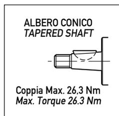
Bloccaggio giunto: n. 1 dado M7, coppia di serraggio 12 Nm.
