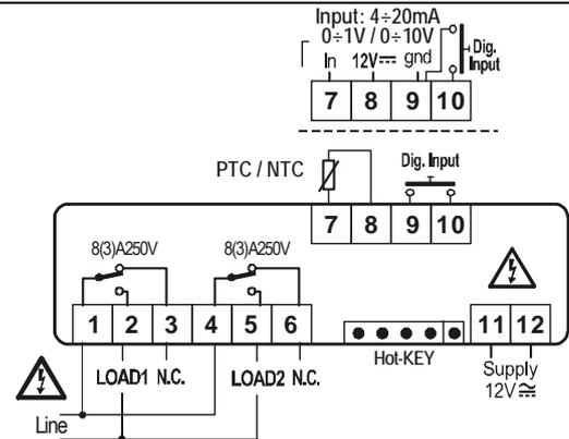
Fühler: Pt100=7 – 9 (8); Thermoele. J, K, S = 7(+); 9(-), 12VAc/dc od. 24VAc/cd Hilfsenergie: 11-12 HOT-KEY Anschluß auch für XJ485 + CAB/RS1 (Dixell-Aufzeichnungssysteme)
