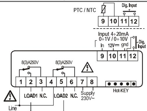
Fühler: Pt100=9 –11 (10); Thermoele. J, K, S = 9(+)- 11(-), 230VAc Hilfsenergie: 8-7 HOT-KEY Anschluß auch für XJ485 + CAB/RS1 (Dixell-Aufzeichnungssysteme)
