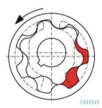
Bei der Konstruktion der BFP Baureihe wurden Anzahl der Zähne und Breite der Gerotoren so gewählt, dass Pumpen mit kleinstmöglichen Einbaumaßen, geringem Gewicht und minimalen Leistungsverlusten entstanden. Durch die geringe relative Geschwindigkeit zwischen Innen- und Außenläufer sind die Pumpen äußerst langlebig und laufruhig.
