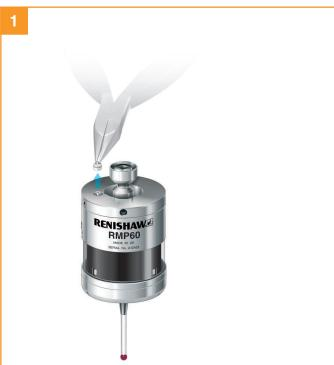
HINWEIS: Soll der RMP60 mit einem Schalter in der Werkzeugaufnahme verwendet werden, muss der Einsatz auf der Rückseite des Messtasters mit Hilfe einer Zange entfernt werden. An dessen Stelle ist dann der Kontaktstift (A-4038-0303) einzusetzen.
