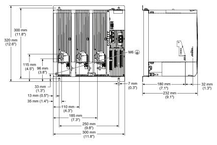
Das Design kann sich ändern bei Geräten mit Lüfter und/oder Nennstrom > 350 A
