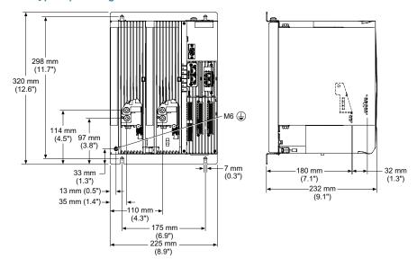
Das Design kann sich ändern bei Geräten mit Lüfter und/oder Nennstrom > 350 A
