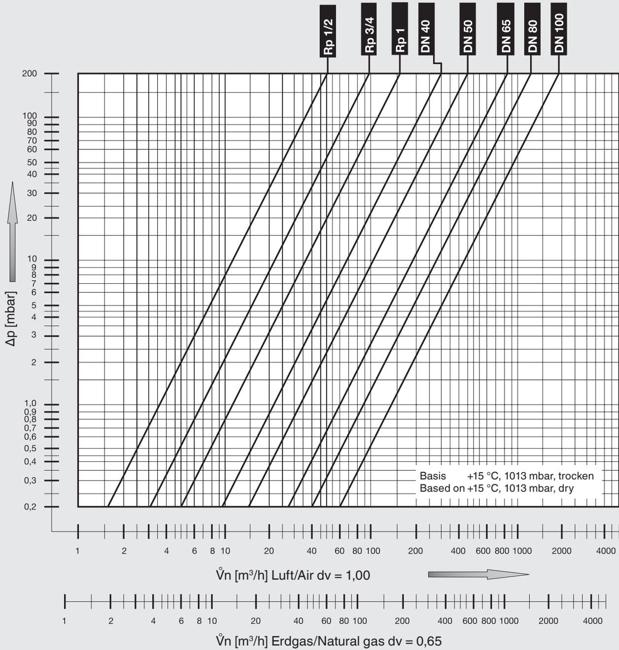
$$\dot{V}_{\text{verwendetes Gas/gas used}} = \dot{V}_{\text{Luft/air}} \times f$$
