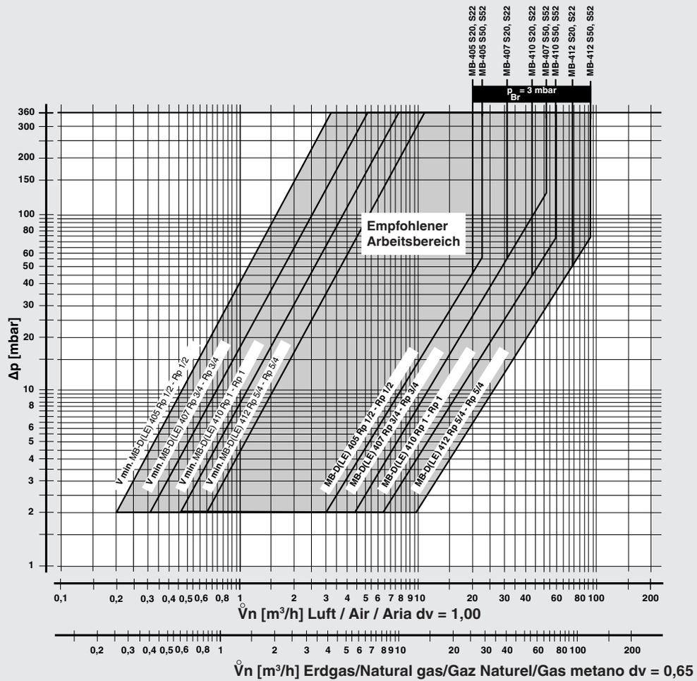
$f = \sqrt{\frac{\text{Dichte Luft}}{\text{Dichte des verwendeten Gases}}}$
