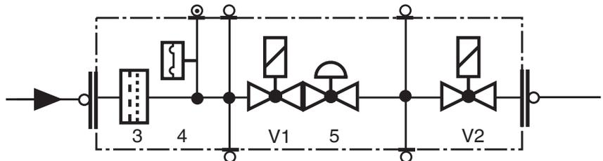
Anbau des Ventilprüfsystem VPS 504 möglich
