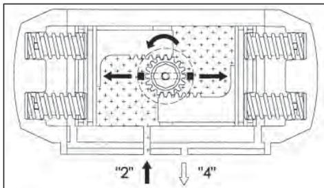
Druckverlust (Luftausfall) an Anschluss 2 ermöglicht den Kolben die Ausgangsstellung anzufahren, Abluft über Anschluss 2, eine Drehrichtung der Welle im Uhrzeigersinn wird erzielt.
