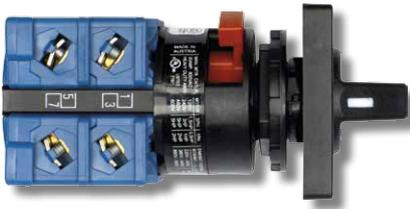
Bei Montage von Schaltern mit Zentralbefestigung sparen Sie Zeit! Diese Befestigungsart ist ca. 5-mal schneller montiert als eine übliche 4-Loch-Befestigung. Alle Schalter mit Zentrallochbefestigung haben die hohe Schutzart IP 66. Die Schalter werden mit einem Frontschild oder einem Frontring geliefert.
