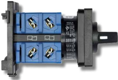
VE1E – Schnellbefestigung auf Normschiene nach EN 60715. Das Frontschild ist mittels Schrauben am Schalter befestigt. Baugröße S00 und S0: empfohlen CG4.., CG8, CH10–CH16 (Baugröße S1: Schalter in Bauform E + S1 M999/D-0031)
