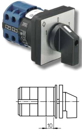
Die Überschaltsperrre verhindert bei Umschaltern ein Durchschalten über die Nullstellung hinaus. Sie ist nur in Verbindung mit 60° Schaltwinkel und schwachem Rastenwerk möglich. Die Überschaltsperrre kann nur in der mittleren Schaltstellung entweder in beide Schaltrichtungen oder nur in eine wirksam sein. (Baugröße S0)
