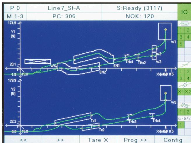
Bild: Messdialog M1-1 Grafische Darstellung der Messkurve. Hier ein Kurvenverlauf mit vor- und rücklaufendem Anteil und detaillierter Bewertung mittels Fenster, Hüllkurven, Schwellen und mathematischer Operationen.
