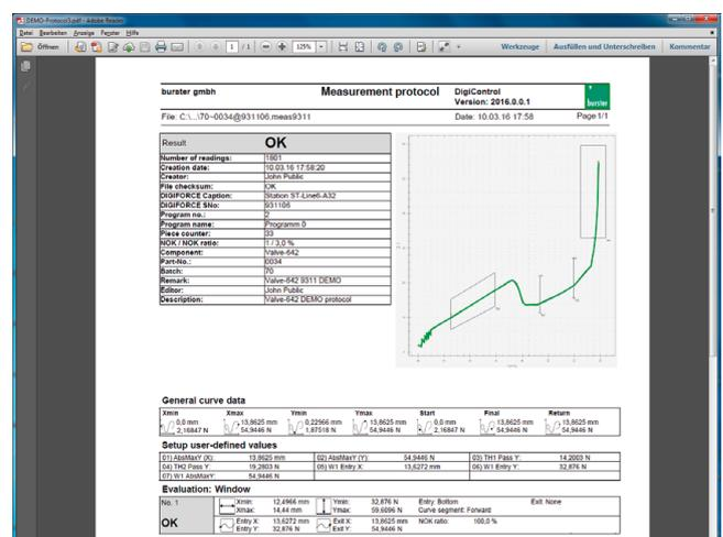
**Bild:** Ein Protokollassistent ermöglicht die gefilterte Auswahl und Darstellung von gespeicherten Messprotokollen. Zu jedem einzelnen Messprotokoll kann ein Protokollausdruck mit Bauteilinformationen, Kurvenverlauf und allen Bewertungsergebnissen generiert werden.
