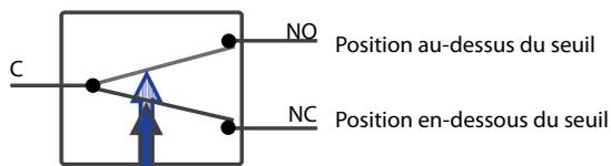
En fonction du type d'action (ouverture ou fermeture du circuit électrique), le raccordement électrique se fera sur le bornier entre C-NC ou C-NO.
