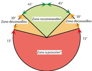
**Zone recommandée :**  $\pm 45^\circ$  de part et d'autre de l'axe vertical, bulbe vers le bas (sortie du capillaire en haut).
