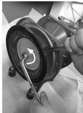
Bild 4: Membran-Demontage
