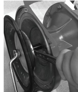
Bild 5: Kontern mit Maulschlüssel
