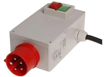
Unterspannungsauslösung nach IEC204-1, EN60204, VDE0113, Abschnitt 7.5., zum Schutz gegen selbstständigen Wiederanlauf nach Spannungseinbruch und Spannungswiederkehr
