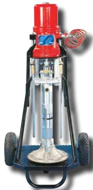
PNEUMATISCH BETRIEBENE RAMMPRESSE mit Druckluftreglern und Manometern
