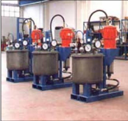
Auf der Abbildung ist ein typisches Beispiel für die Installation einer pneumatischen Kolbenpumpe zur Umfüllung gezieht.
