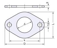
Rundflanschdichtungen aus ELAPAC-FD wie auf Seite 381 beschrieben, zusätzlich mit außen offener PTFE-Ummantelung 0,4mm dick. Geeignet für alle Medien gemäß Übersicht auf Seite 396 Spalte **TM**.
