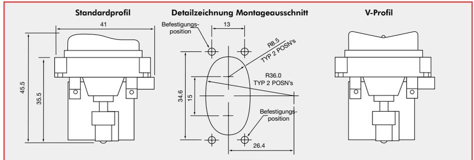
Die empfohlene Plattendicke ist 3 mm. Der mitgelieferte O-Ring muss verwendet werden, um die Dichtigkeit des JC025 gegen die Montageplatte in Schutzart IP65 zu gewährleisten.
