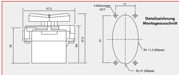
Die empfohlene Plattendicke ist 3 mm. Der mitgelieferte O-Ring muss verwendet werden, um die Dichtigkeit des JC030 gegen die Montageplatte in Schutzart IP60 zu gewährleisten. Mitgeliefert werden 4 selbstschneidende Pozidrive Rundkopfschrauben.
