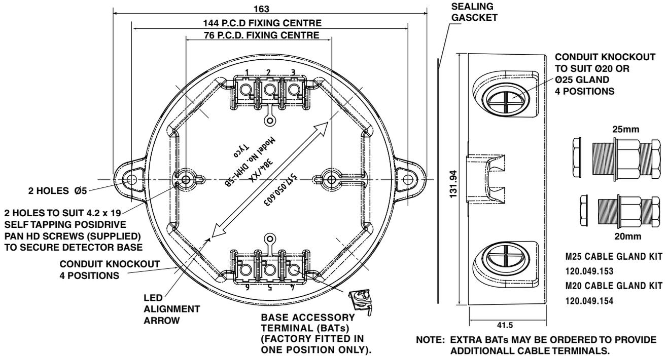
Fig. 5 DHM-5B Deckhead Mounting
