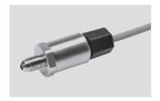
Die kompakten Drucktransmitter der Typenreihe 520 basieren auf der von Huba Control entwickelten Dickschicht-Technologie, bei der die Druckmesszelle dichtungsfrei mit dem Druckaufnehmer verschweisst ist.
