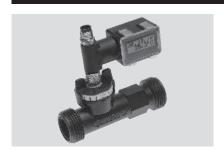
Der Durchflusssensor vom Typ 212 basiert auf dem Prinzip der Kármánschen Wirbelstrasse und hat eine Digitalanzeige, die den Durchfluss und die Mediumstemperatur anzeigt.
