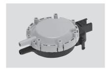
Die Drucktransmitter der Typenreihe 402 mit bewährter Keramik-Biegebalkentechnologie haben abgeglichene, temperaturkompensierte Sensorsignale, die als Spannungsausgänge zur Verfügung stehen. Sie sind ideal einsetzbar zur Erfassung kleiner Luftströmungen in der Klimatechnik und zur Messung von feinen Drücken im Umwelt/Medizinal-Bereich
