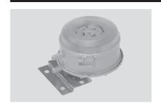
Als Strömungswächter in  $\Delta P$  Funktion überwachen die Druckwächter der Typenreihe 604 in Lüftungskanälen Filter, Ventilatoren und in Primär-/ Sekundärregelungen Luftklappen. Zudem eignen sich die Druckwächter 604 ideal als Überhitzungsschutz bei Lufterhitzern oder zur Überwachung von industriellen Kühlluftkreisen. Medium: Luft und nicht aggressive Gase.
