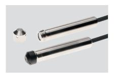
Die Tauchsonde 711 ist mit einer Relativdruckmesszelle ausgestattet und wandelt den hydrostatischen Füllstandsdruck in ein 4 ... 20 mA Ausgangssignal um. Zusätzlich sind Kabellängen von 3 bis 300 Meter verfügbar. Ebenso sind Varianten mit Explosionsschutz sowie mit Trinkwasserzulassungen erhältlich.
