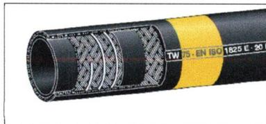
Tankwagenschlauch 'Gelbring' mit abknickfester Stahlwendel, innen und außen glatt. Für Mineralölprodukte aller Art mit Aromatenteil bis 50%. Temperaturbereich -30° bis +90° C. Elektrischer Widerstand <math><10^6</math> Ohm. Bauartzugelassen nach Norm VG 95 955 Typ S. Entspricht EN 12115 und EN 1761. Type STW = verstärkte TW-Ausführung. Besonders geeignet als Marine-Bunkerschlauch (Einzelheiten siehe Seite 129).
