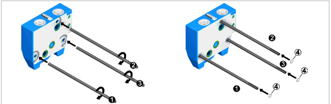
Fig. 4: Subplate assembly
