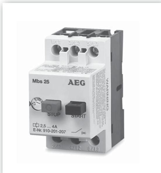
I salvamotori AEG dispongono dell'alto potere di interruzione di corto circuito degli interruttori di potenza, pur con dimensioni molto ridotte che oltretutto permettono il montaggio su quadri di distribuzione modulari. Possono essere impiegati come interruttori principali e interruttori di emergenza secondo VDE0113.
