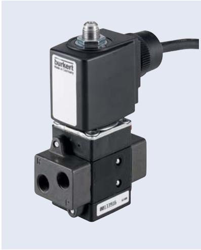
Die Zulassung Ex m wird durch die Bestückung des Ventiles mit einer entsprechenden übergesteckten Spule erreicht. Der Kabelanschluss und das Kabel sind unlösbar mit der Spule vergossen. Die Ventile sind einzeln oder auf Blöcken einsetzbar.
