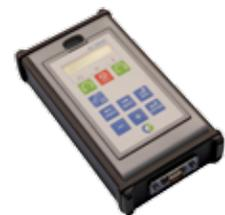
Handsteuergerät mit voller Funktionalität. Zur vorübergehenden Nutzung einfach an den Frequenzrichter anzuschließen, z. B. bei Inbetriebnahme und Wartung. Das HCP 2.0 ermöglicht die Einstellung der Parameter und die Anzeige von Istwerten sowie Störungsprotokollen. Zudem bietet es die Möglichkeit, Parameterdaten von einem Frequenzrichter zu anderen Frequenzrichtern zu kopieren.
