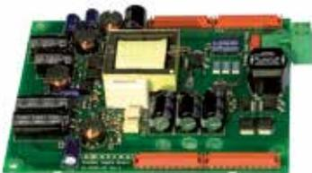
Integrierte Platine für die externe Spannungsversorgung.
