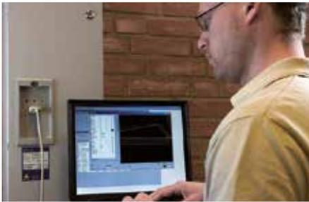
Schließen Sie einen PC mit einem RS232-Standardkabel unter der Bedieneinheit an der Vorderseite an. Die PC-Software EmoSoftCom ermöglicht Signalaufzeichnungen und das Speichern/Laden von Parameter-Datensicherungen, z. B. während Wartungs- und Reparaturarbeiten.
