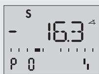
Angezeigt wird Code **P0**, das Störmeldesymbol **S** und **S** für die Sicherheitsstellung.
