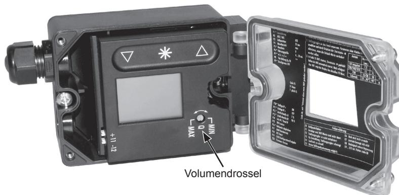
**Abb. 13: Einstellung der Volumendrossel Q (Stellung MAX/MIN)**
