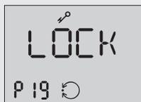
**LOCK** und das Schlüssel-Symbol zeigen an, dass die Konfiguration gesperrt ist. Sperrung folgendermaßen aufheben:
