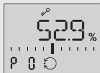
Angezeigt wird Code **P0**, Stellungsregler befindet sich im Regelbetrieb, erkennbar am Regelsymbol
