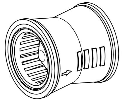
Membran-Stützeinheit: verstärkter Kunststoff
