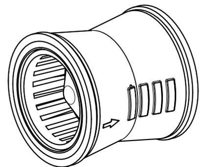
Membran-Stützeinheit: verstärkter Kunststoff
