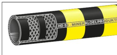
Hochdruck-Tankschlauch 'Gelbring' ohne Wendel. Ideal als Trommelschlauch für Mineralölprodukte aller Art. Temperaturbereich -30° C bis +90° C (kurzzeitig bis +110° C). Elektrischer Widerstand <math><10^6</math> Ohm. Entspricht EN 1761. Bauart zugelassen nach Bundeswehnorm VG 95 955 Typ D. Eichfähig nach europäischen Richtlinien. Entspricht EN 12115.
