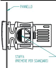
Die Tafleinbau-Geräte XR40C sind für einen Ausschnitt 71x29 mm vorgesehen und werden mit zwei Befestigungsbügel fixiert. Die Befestigungsbügel von hinten aufschieben und durchschieben bis beide Bügel fest einrasten.
