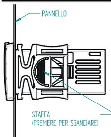
Die Tafel einbau-Geräte XR60C sind für einen Ausschnitt 71x29 mm vorgesehen und werden mit zwei Befestigungsbügel fixiert. Die Befestigungsbügel von hinten aufschieben und durchschieben bis beide Bügel fest einrasten.
