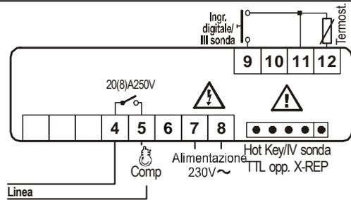
Bei 12Vac/dc, 24Vac/dc, 110Vac und 230Vac: Anschlüsse 7 und 8.
