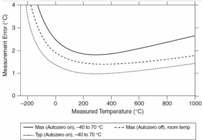
**Thermocouple Type B Errors**
