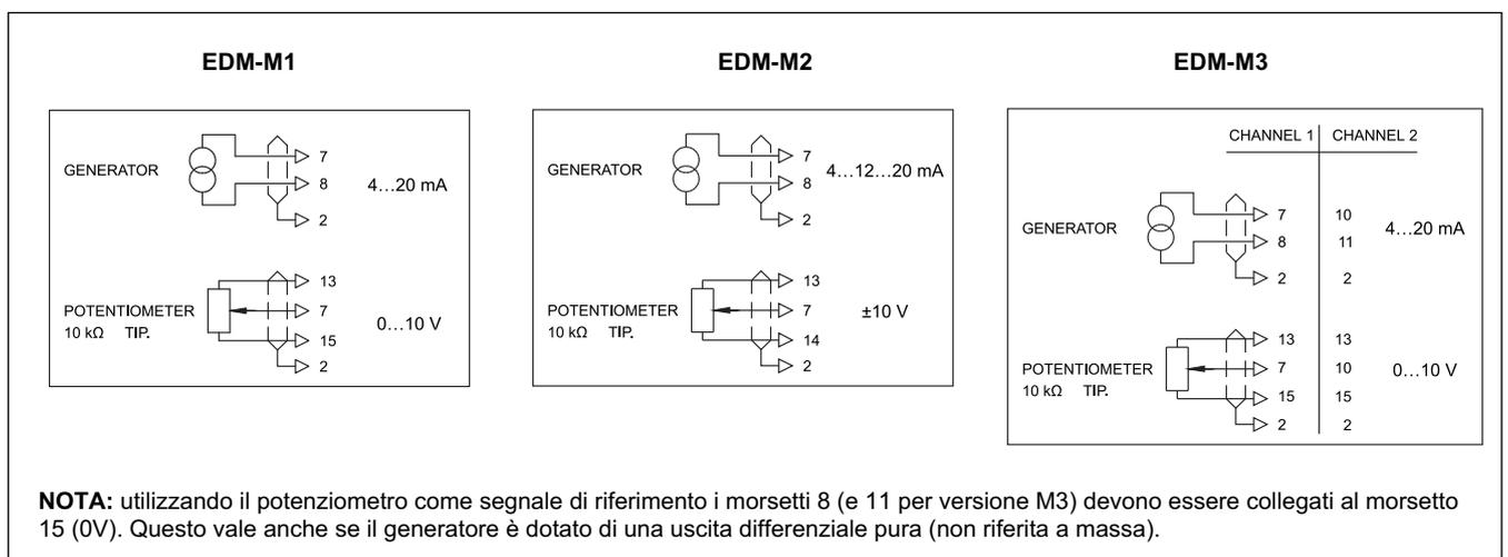
**NOTA:** utilizzando il potenziometro come segnale di riferimento i morsetti 8 (e 11 per versione M3) devono essere collegati al morsetto 15 (0V). Questo vale anche se il generatore è dotato di una uscita differenziale pura (non riferita a massa).
