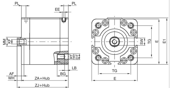
**Ausführung mit durchgehender Kolbenstange,
