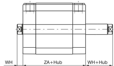
**Tandemausführung mit gegenläufiger Kolbenstange**
