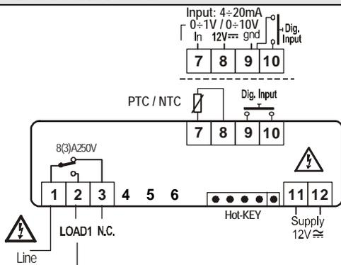
Fühler: Pt100= 7 - 9 (8); Thermoel. J, K, S = 7(+); 9(-), 12VAc/dc od. 24VAc/cd Hilfsenergie: 11-12
