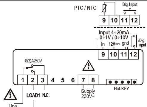
Fühler: Pt100=9 -11 (10); Thermoel. J, K, S = 9(+)- 11(-), 230Vac Hilfsenergie: 7-8
