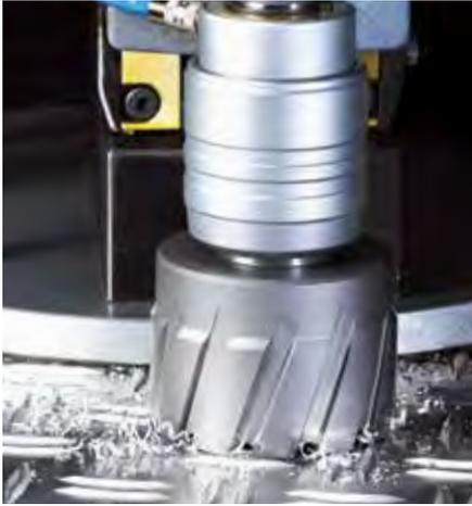
BDS-Kernbohrer werden auf modernen CNC-gesteuerten Schleifzentren produziert. Das garantiert gleichbleibende Schliffausführung, Qualität und Schnittleistung aller BDS Bohrwerkzeuge im gesamten Programmspektrum.
