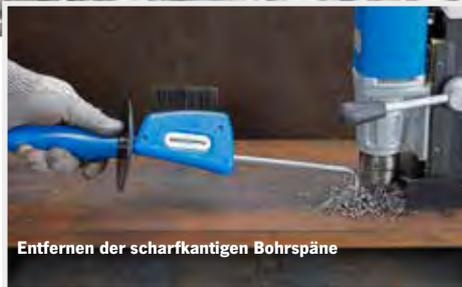
Entfernen der scharfkantigen Bohrspäne
