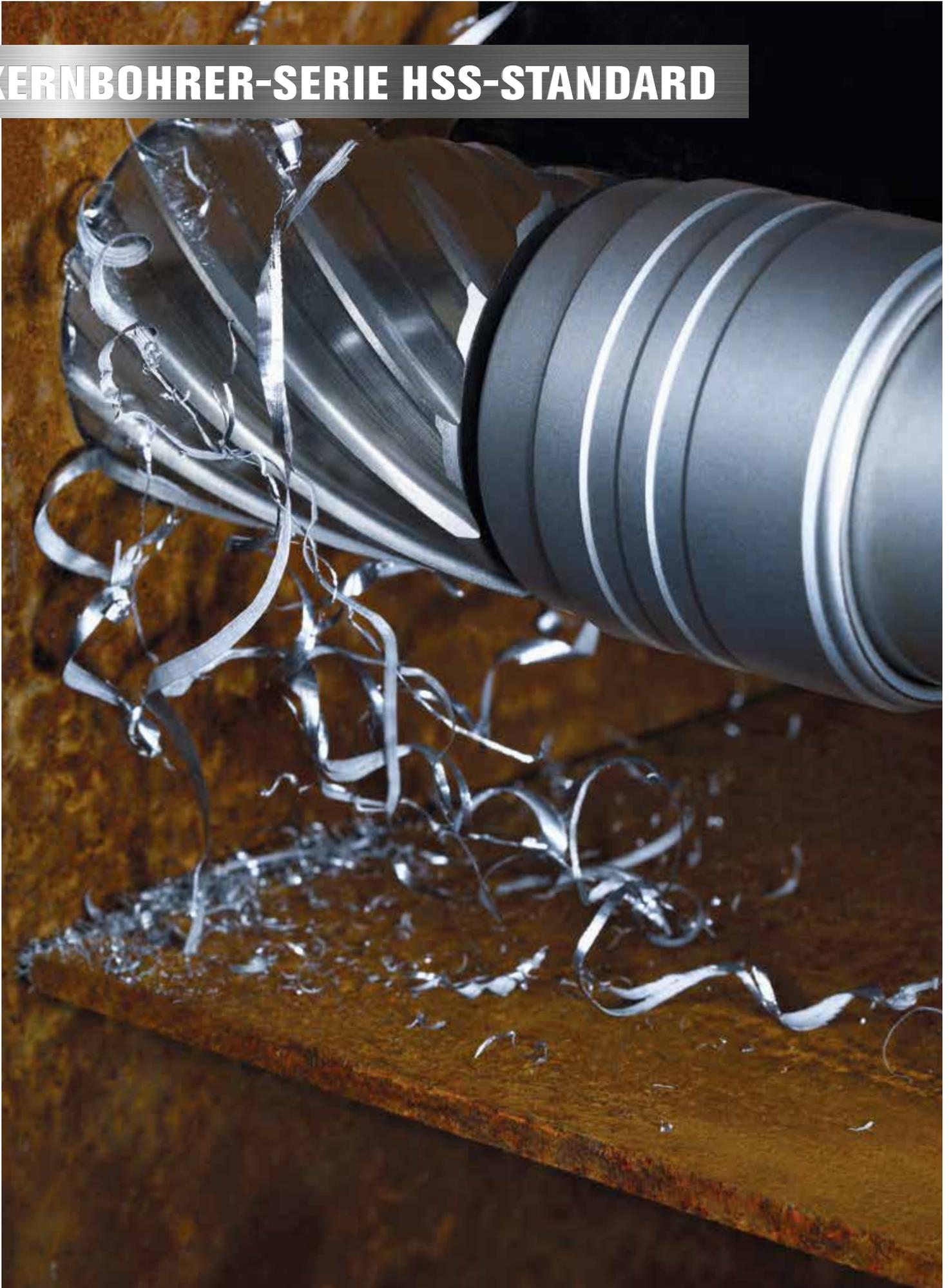
Das Kernbohrer-Basissortiment für den professionellen Einsatz. Vollschliff-Kernbohrer aus Hochleistungsschnellstahl auf CNC-gesteuerten Schleifzentren gefertigt, mit guter Spanableitung. Bohren mit geringem Kraftaufwand. Für horizontale Arbeiten empfiehlt BDS das Hochleistungsfettspray BDS 5200.
