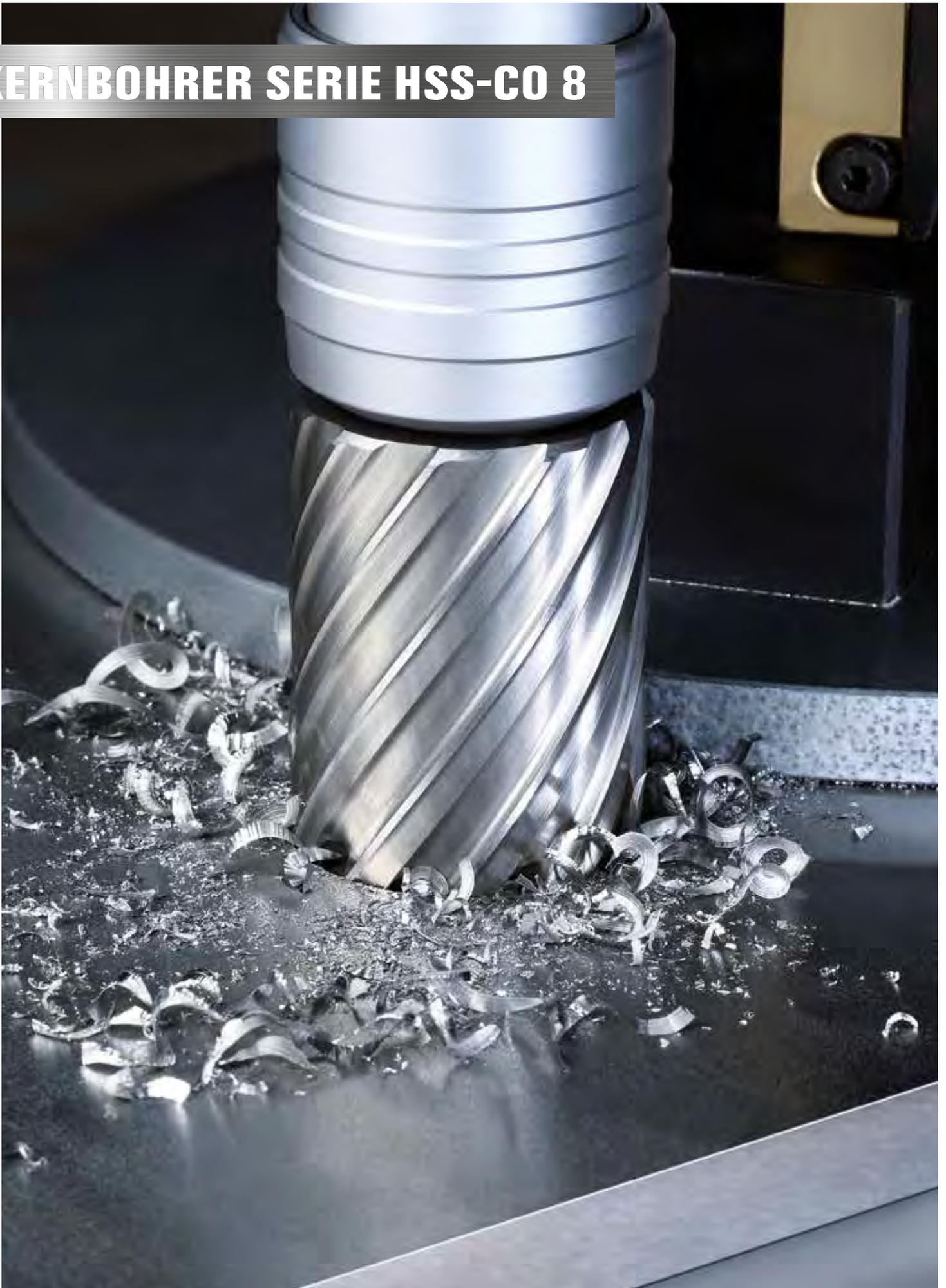
Die Bohrer dieser Serie zeichnen sich durch hohe Hitzebeständigkeit und Verschleißschutz aus. Sie sind in Kombination mit drehzahlgesteuerten BDS-Magnet-Kernbohrmaschinen zur Bearbeitung von Feinkornstählen und rostfreiem Material geeignet. BDS empfiehlt für die Bearbeitung von Edelstahl das Schneidöl BDS 5000.
