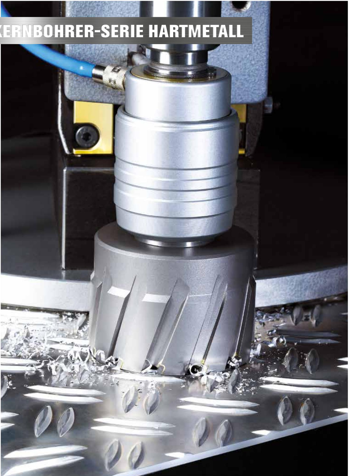
**BDS-Kernbohrer mit Hartmetallbestückung. Serie mit Schnitttiefen von 30 mm, 35 mm, 55 mm, 75 mm und 110 mm und nahezu lückenlosen Abstufungen der Durchmesser von Ø 12 mm bis Ø 150 mm. BDS empfiehlt zur Bearbeitung von Edelstahl und NE-Metallen das Hochleistungs-Kühlschmierkonzentrat BDS 6000.**
