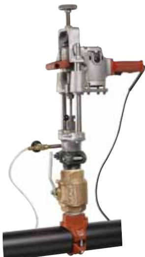
Das Vic-Tap II Lochschneidewerkzeug ist für den Einsatz mit Typ 931 Vic-Tap II Mechanical-T-Einheiten konzipiert, einer Kombination eines Mechanical-T-Typ 920 mit einem Vic-Ball-Ventil der Serie 726. Das Vic-Tap II ist in der Lage, Löcher in Kohlenstoffrohr-Systeme bei einem Druck von bis zu 500 psi/3450 kPa zu schneiden.
